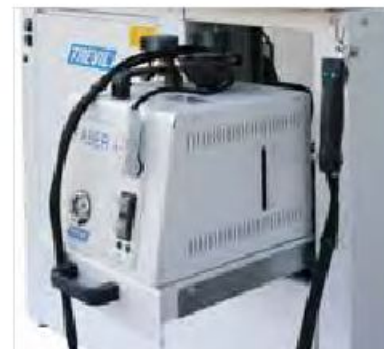
Практичный автономный парогенератор с паровоздушным пистолетом для «горячей» пятновыводки удобно расположен для наполнения и обслуживания.
