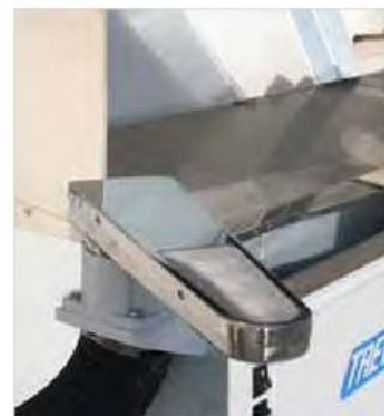
Лапка для пятновыводки поворачивается наружу, полностью освобождая внутреннее пространство.
