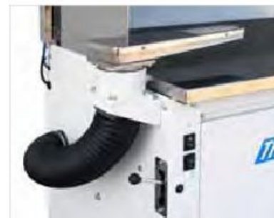
Практичная рукоятка позволяет переключать поток препаратов между кабинетом и пятновыводной лапкой.
